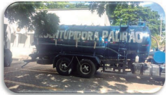
Foto 02 – Limpezas de Caixas de Gorduras e Esgoto
