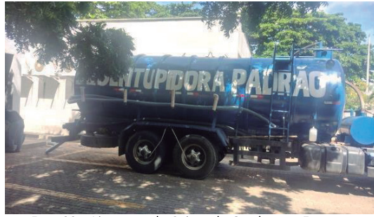
Foto 02 – Limpezas de Caixas de Gorduras e Esgoto
