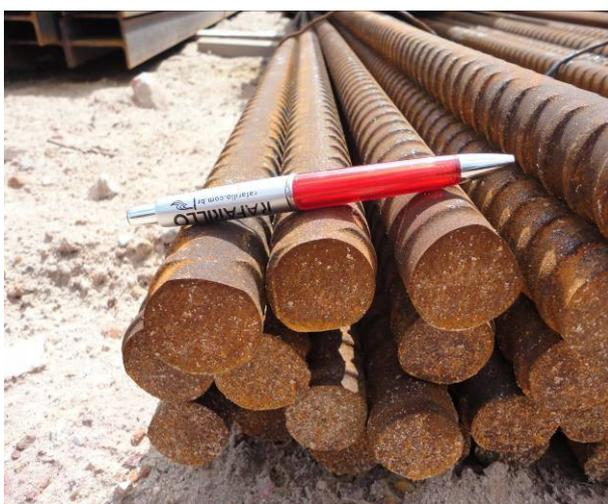
Foto 3: Espessura do aço utilizado nos tirantes
